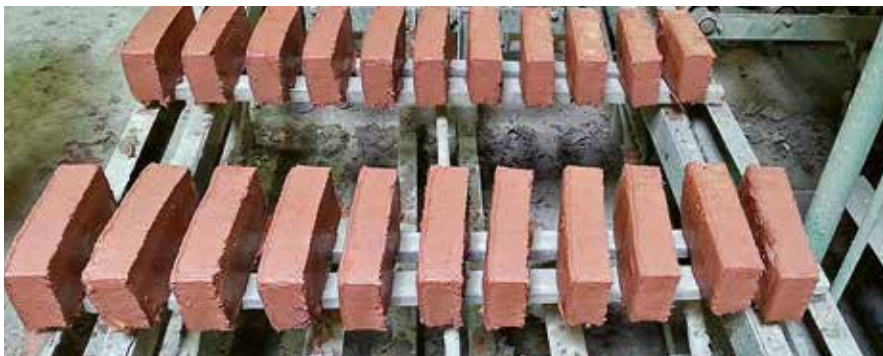
ZUSÄTZLICHE PRODUKTSCHIENE: Die Filterkuchen, mit der Kammerfilterpresse aus Feinstgutsedimenten erzeugt, eignen sich für die Ziegelproduktion.
